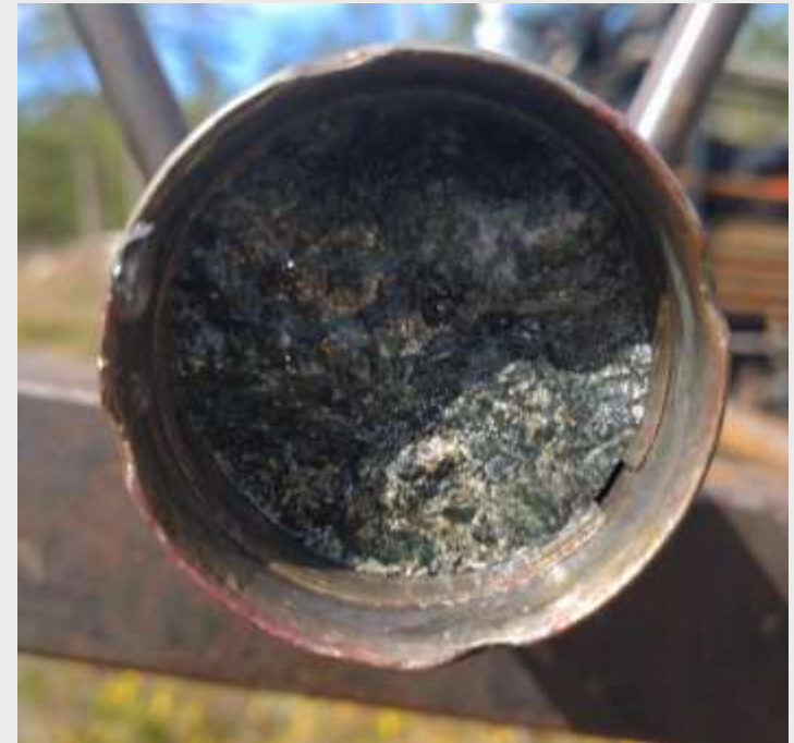
Borrkärna från hål nr 6 på den västra anomalin.
